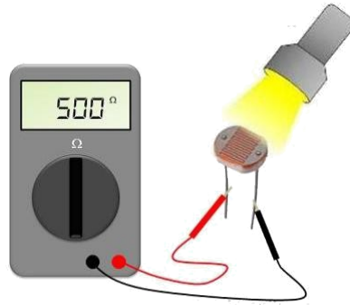
Gambar 2. Cara pengukuran ketika LDR di beri cahaya
