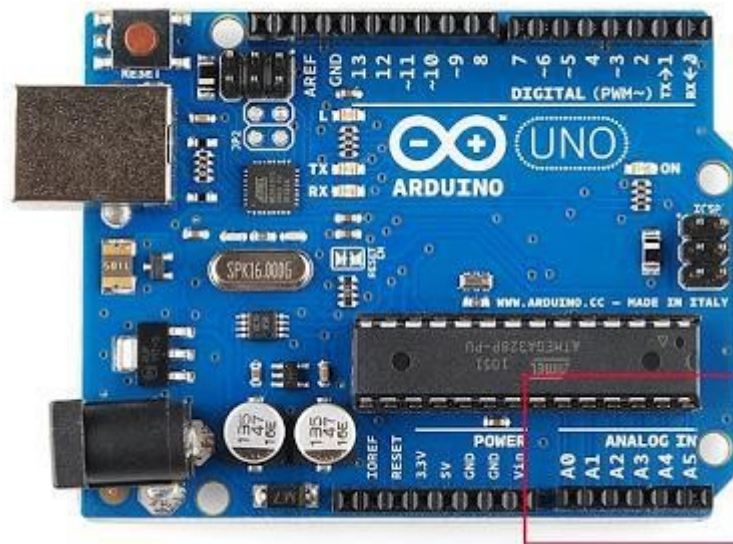
Gambar 2. Pin Analog Pada Arduino Yang Bisa Digunakan Untuk Memproses Data Analog
