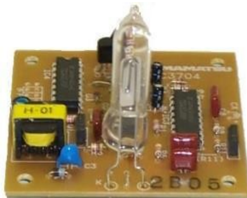
Gambar 6. Bentuk Fisik Modul Sensor Cahaya Uvtron
