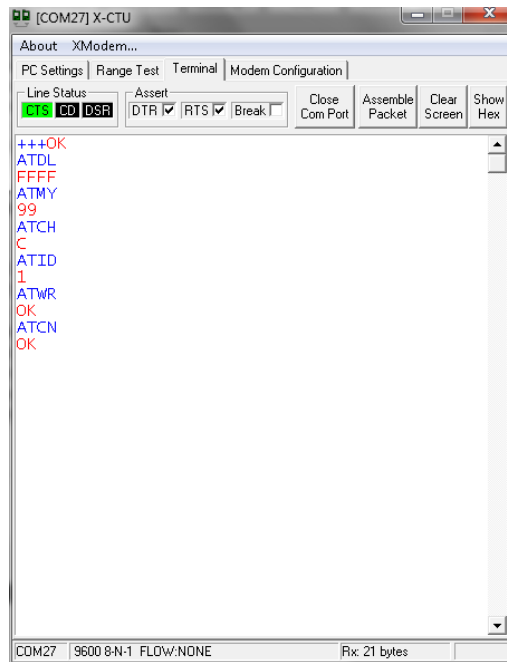
Gambar 5. Contoh Penggunaan ATCommand pada X-CTU Terminal
