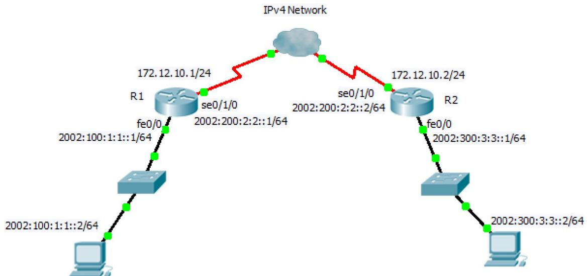
Gambar 1. Desain Jaringan dengan tunneling
