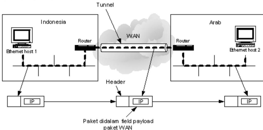
Gambar 2. Tunneling suatu paket dari Indonesia ke Arab
