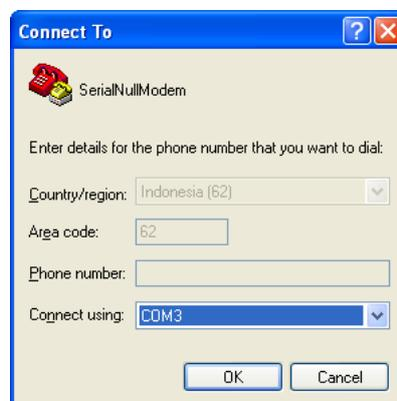
Untuk mengetahui port COM yang digunakan, klik kanan pada My Computer dan pilih properties.
