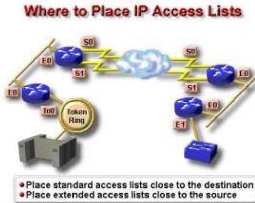
Gambar 3. Penempatan Standard dan Extended Access List
