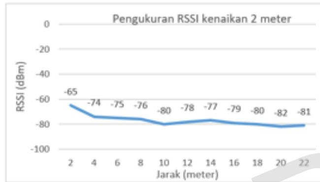
**Gambar 4.18.** Grafik RSSI dengan kenaikan jarak 2 meter
